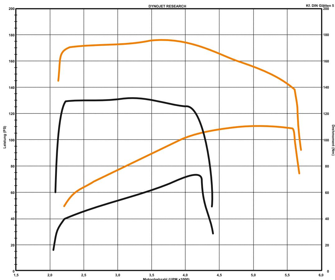
■ TORXSTER M8 /117, Max. Power = 122 PS (Motorenleistung), Max Drehmoment = 178 NM
